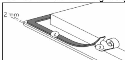
Kleef de pakking (2) op twee millimeter van de externe rand van het glas, na het verwijderen van de beschermfolie (3).
